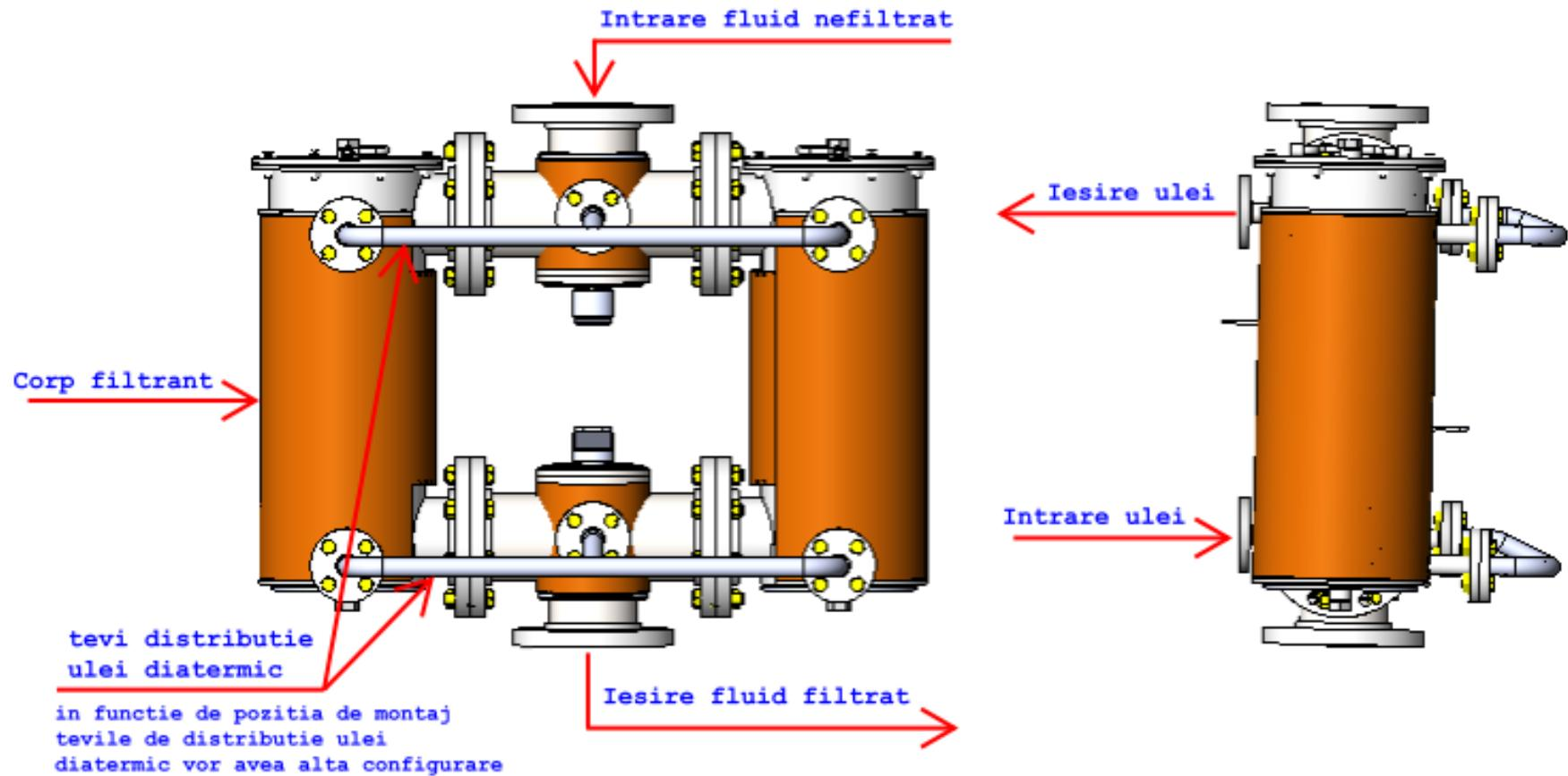
Cod de comanda a unui filtru bitum baipas incalzit cu ulei
